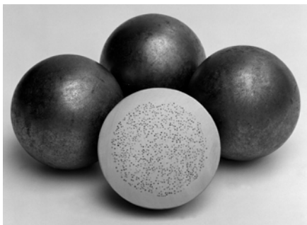
Foto: Brennelementkugeln des Hochtemperaturreaktors. In der aufgeschnittenen Kugel ist die Innenzone mit den Brennstoffpartikeln erkennbar.
